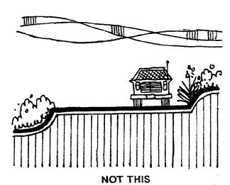
ACCESS ROAD MAINTENANCE SHOULD NOT EXPAND THE EXISTING ROAD BED
