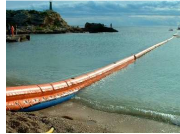
Fig. 5 Tidal Seal Boom
