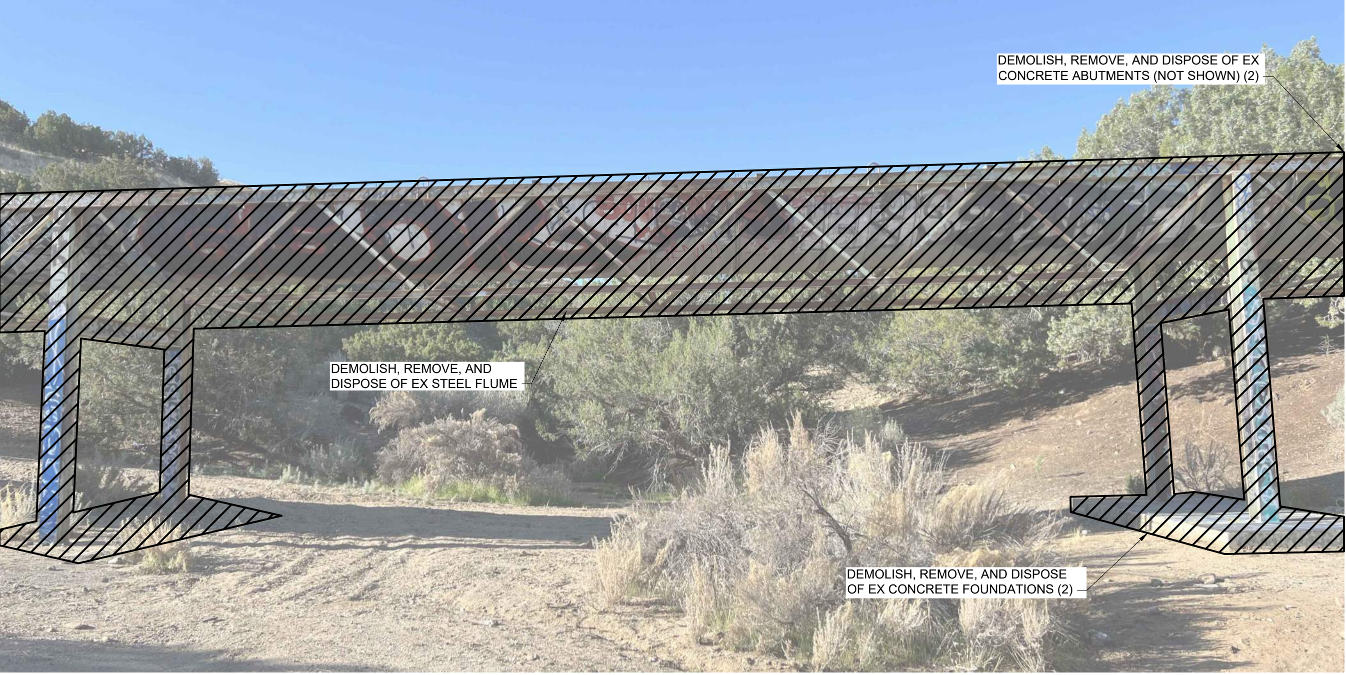
EX STEEL FLUME REMOVAL STA 103+00
